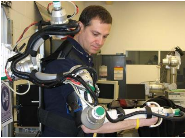
Figure 2 - The MGA Exoskeleton [Carignan et al. 2009]
